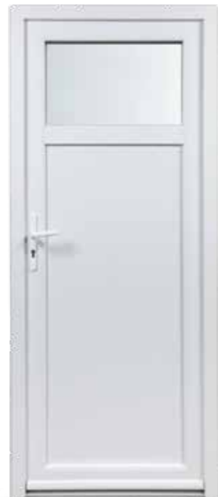
Porte de service PST Partie haute vitrée de 350mm de jour Vitrage peu émissif argon 4.20.4 intercalaires alu noir Panneaux sandwich rainuré 1 face côté extérieur
