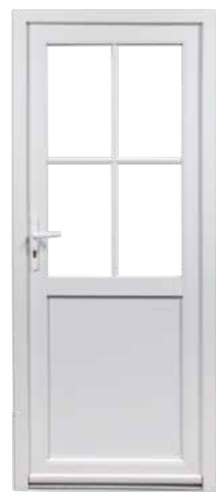
Porte de service PSC Petits bois 4 carreaux alu blanc26/8 Vitrage peu émissif argon 4.20.4 intercalaires alu noir Soubassement de 900mm panneau sandwich lisse
